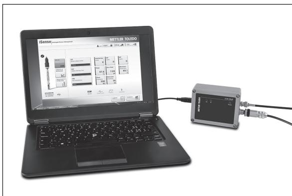
ใช้สายเคเบิล USB ที่ใหมาด้วยเพื่อเชื่อมต่อ iLink Multi กับคอมพิวเตอร์/แล็ปท็อป
