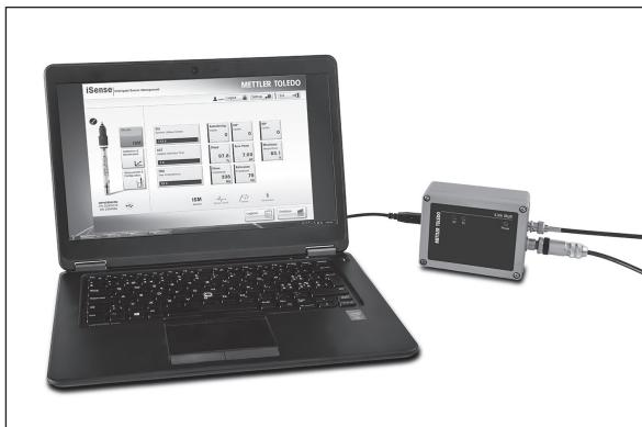
Для подключения iLink Multi к ноутбуку или ПК используйте прилагаемый USB-кабель.
