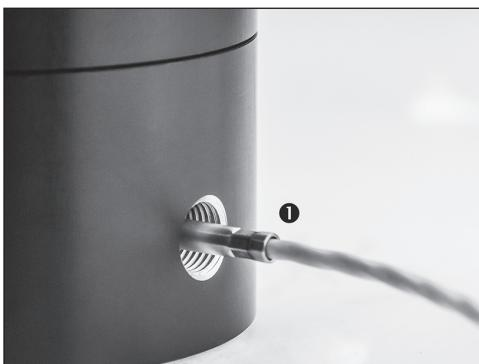
❶ CalBox с установленным датчиком температуры
