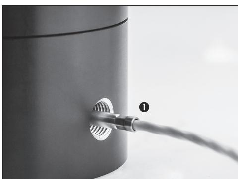
① CalBox com sensor de temperatura montado
